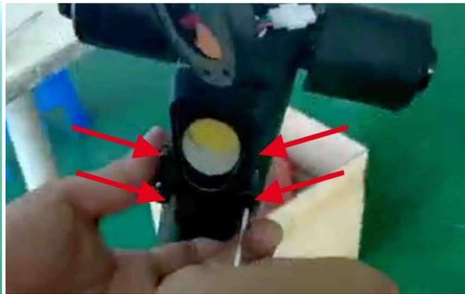
Etape 6 : Vous pouvez alors désolidariser la pièce support basse guidon n° 45 de la pièce de rotation haute tube avant n° 44. Notez que la pièce n°45 est toujours solidaire des pièces situées au-dessus i.e ensemble des pièces formant le guidon.
