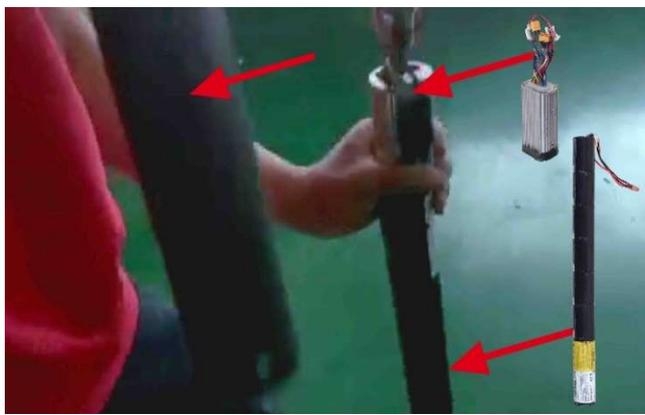
Notez que la batterie et le contrôleur sont tous 2 situés dans le tube avant. Débrancher alors la batterie du contrôleur pour l'isoler.
